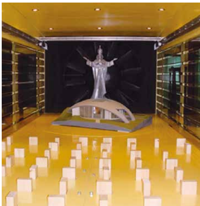
Model gipsowy Pomnika i Centrum na stole obrotowym przestrzeni pomiarowej tunelu aerodynamicznego Politechniki Krakowskiej
